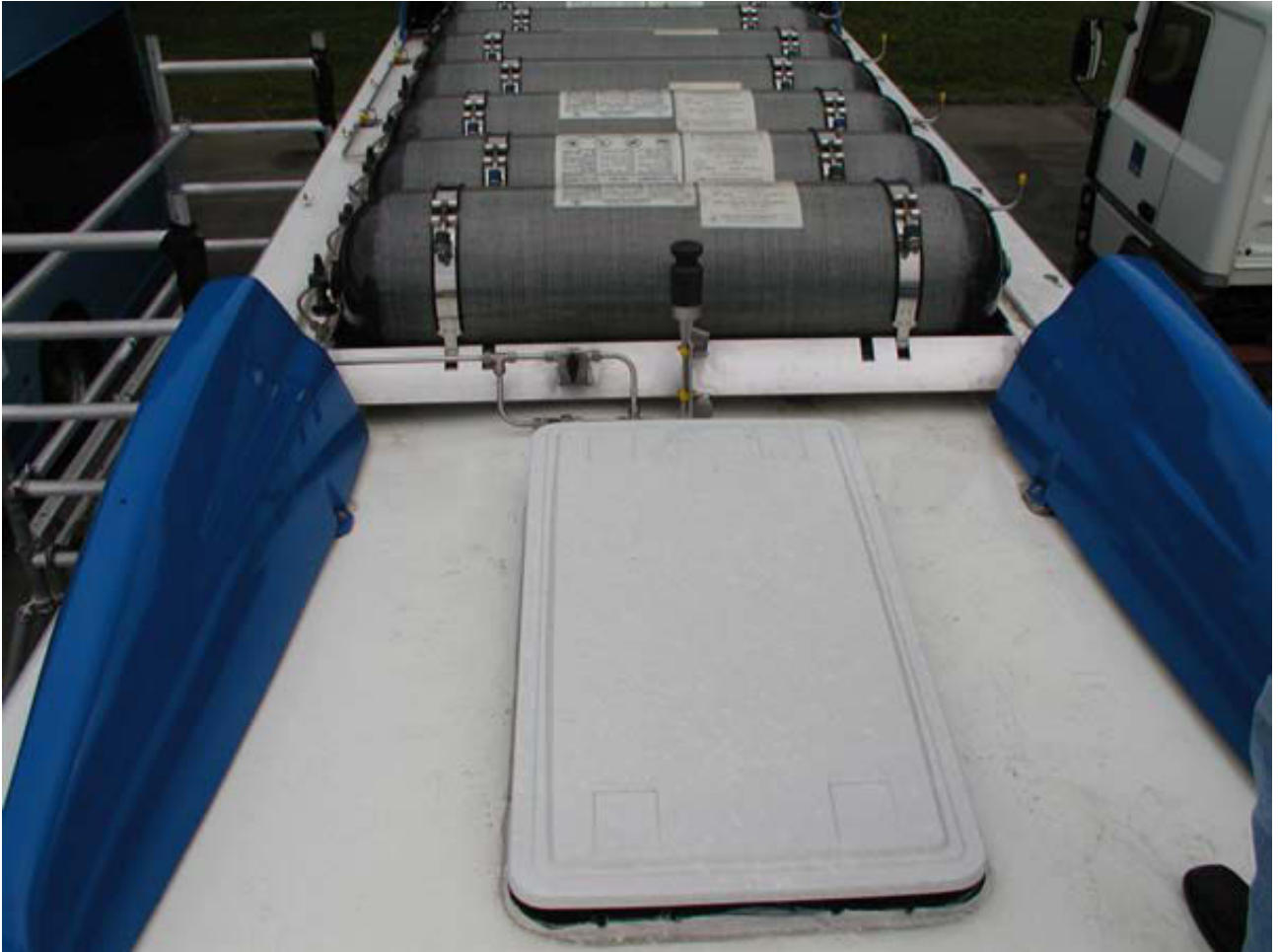
GX 317 identique à celui détruit (Montbéliard) avec une vue des réservoirs et de la trappe du toit
